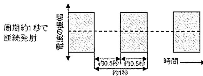
図 1-3 影響測定での電波の発射状態
