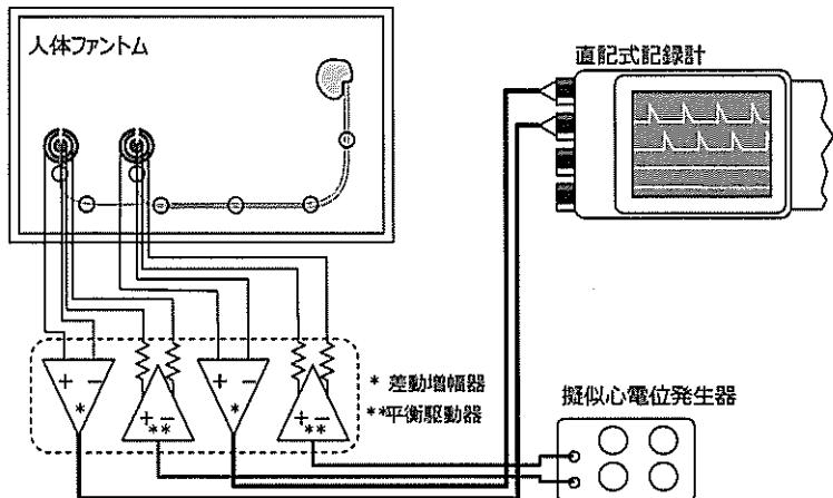
(差動増幅器及び平衡駆動器は擬似心電位発生器内に含んでいる)
