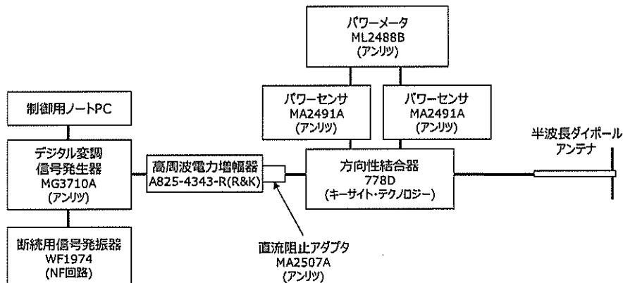
図 1-1 模擬システムの構成概要ブロック図
