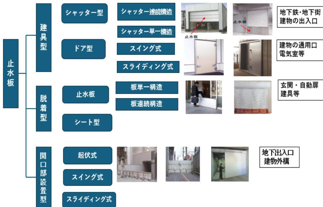
(写真：国土交通省・経済産業省「建築物における電気設備の浸水対策ガイドライン」
